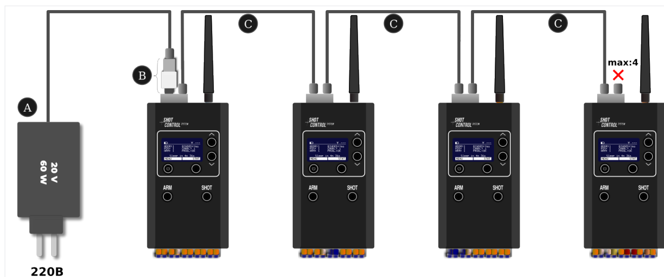
Рис. 19: Зарядка 4-х устройств SBOX-30
