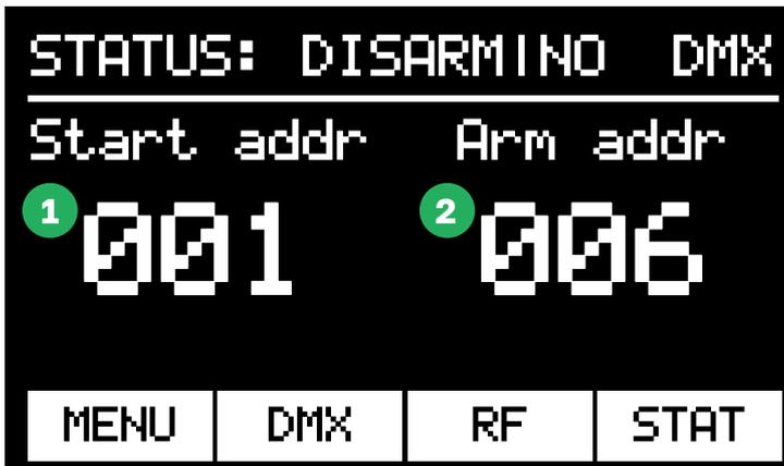
В левой части экрана отображается стартовый адрес Start addr (1), а в правой - адрес зоны безопасности Arm addr (2). Прибор входит в состояние ARM по DMX только если канал, установленный в правой части (Arm addr) принимает значение от 120 до 130.
