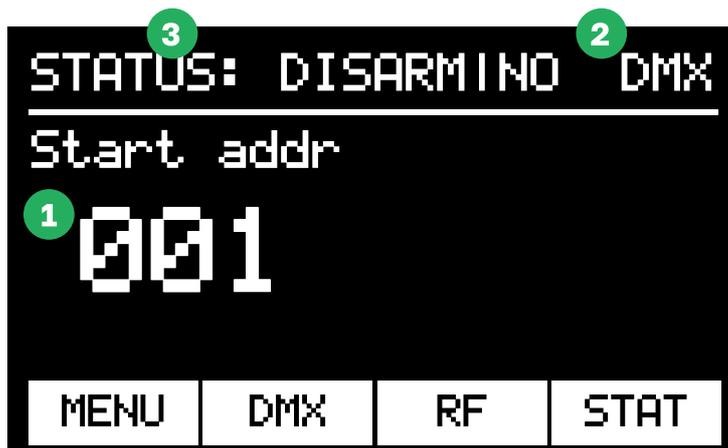
Отображается только стартовый адрес Start addr (1). Прибор входит в состояние ARM по DMX только когда подан DMX сигнал на вход устройства. Когда статус DMX (2) в правом верхнем углу экрана принимает значение OK, то STATUS (3) в левом верхнем углу экрана автоматически принимает значение ARM.
